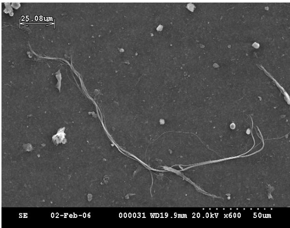
Figura 1 – Microscopia electrónica de varrimento mostrando fibras de amianto crisótilo
